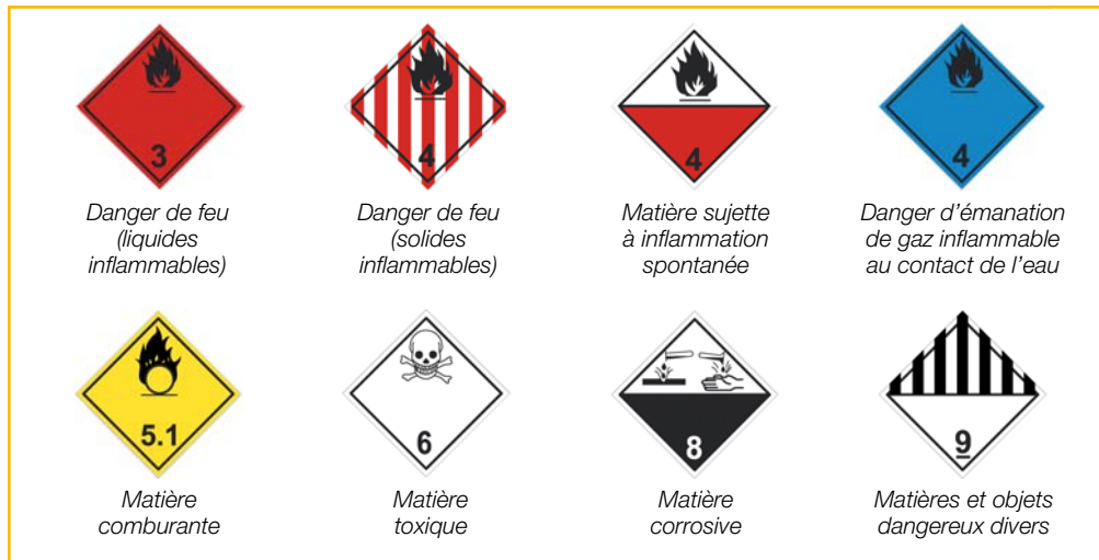
Les pictogrammes de "danger au transport" apposés sur l'emballage ou le suremballage
